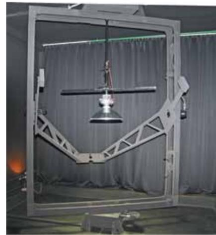
Фото рамы с подвешенным светильником – Гониофотометр RIGO 801
