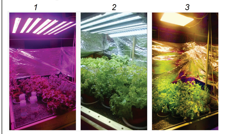
Рис. 4. Фото фито-установок. 1 - с красно-синими СД-облучателями; 2 - с белыми СД-облучателями; 3 - с НЛВД.
